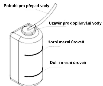
Vodní krytka Horní mezní úroveň Dolní mezní úroveň
