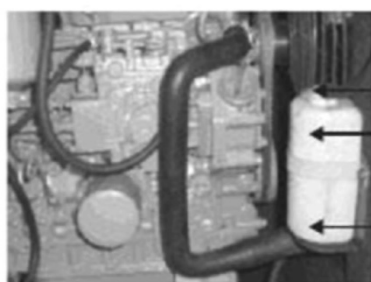
Vodní krytka Horní mezní úroveň Dolní mezní úroveň
